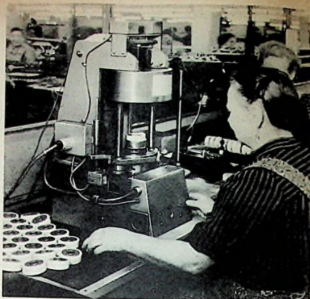
Bild 7. Magnetisieren der fertig montierten keramischen Magnetsysteme
