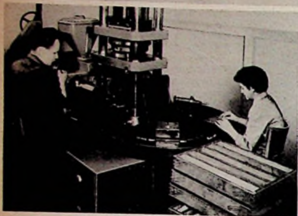
Bild 6. Das Umspritzen der Magnetsysteme mit Polyamid
